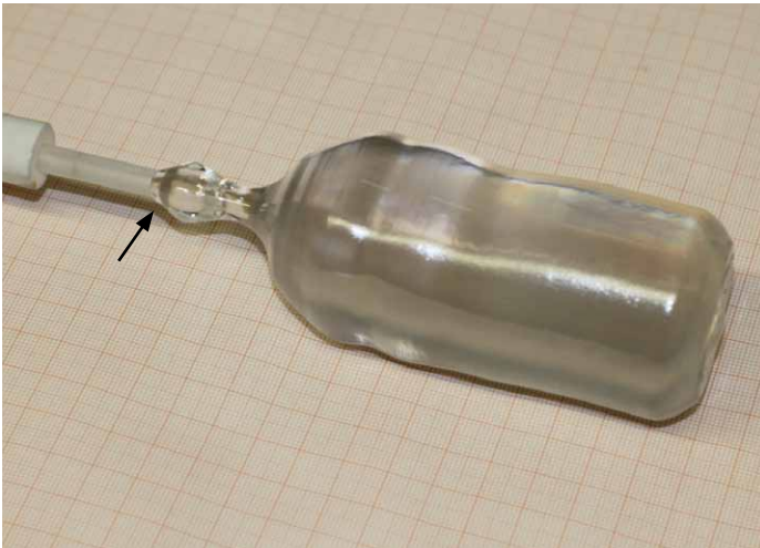
Kristall aus Kalziumwolframat (1 Kilogramm) nach 18-stündiger Züchtung: Zu sehen ist auch der keramische Keimhalter, aus dem der orientierte Keim herausragt, ist zu sehen. Der Pfeil markiert die Ankeimstelle.
