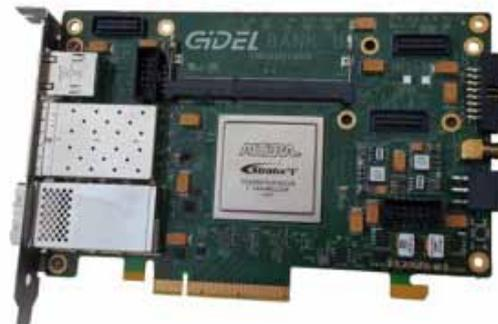
*Um die Mustererkennung eines Track-Triggers mit Neuronalen Netzen zu testen, müssen die Algorithmen auf spezielle Hardware portiert werden.*
