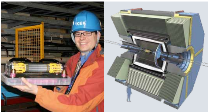
Links: Klein aber präzise – Jochen Schieck zeigt das Modell des PXD. Rechts: Schema von Belle II – der PXD wird zentral am Kollisionspunkt eingebaut.
